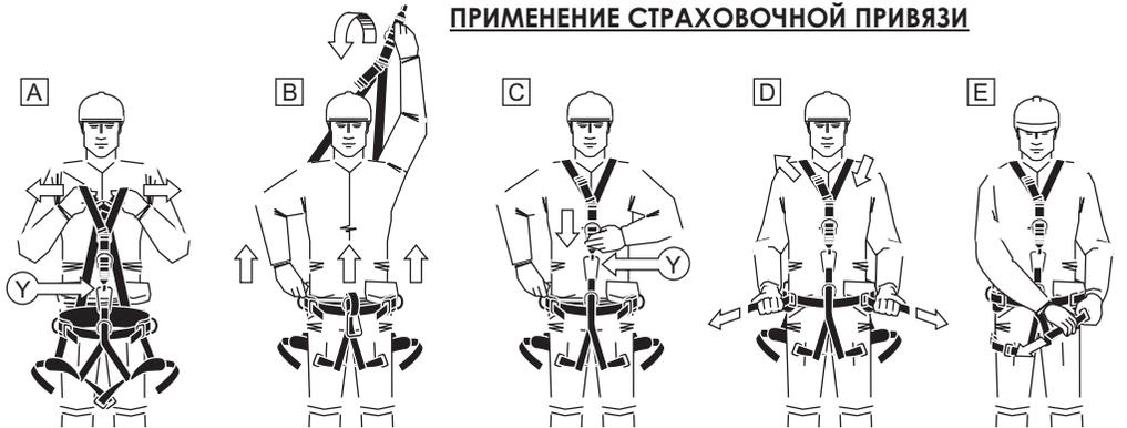
**A.** Взять привязь за наплечные ремни. Отсоединить наплечные ремни от замка [Y].
