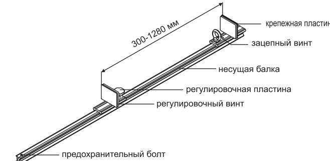
**МОНТАЖ БАЛКИ** - Зацепную балку следует монтировать в стабильном оконном или дверном проеме, обладающем статической прочностью не менее 15 kN. Балка должна быть установлена в горизонтальном положении на внутреннем основании проема. Запрещено монтировать балку в вертикальном положении.
