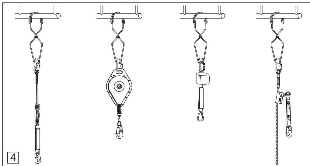
К ножничному засцепу присоединить соединительно-амортизационную подсистему, например, амортизатор с тросом, самотормозное устройство, рабочий трос самозажимных устройств.
