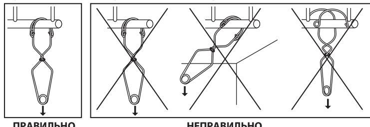
Перед каждым применением оборудования для защиты от падения с высоты, компонентом которого является засцеп, следует проверить, что все устройства надежно соединены друг с другом, работают без каких-либо нарушений и соответствуют действующим стандартам:
